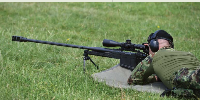
„Црна стрела” – снајперска далекометна пушка 12,7 mm M93 с оптичким нишаном M-94 8x56
