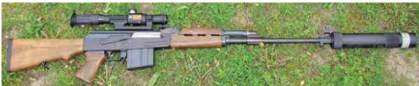
Полуаутоматска снајперска пушка 7,9×57 mm М76 са пригушивачем пуцња произвођача „Телеоптик”
